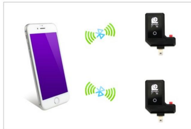
**通用型USB数据采集适配器(模拟键盘型)**
